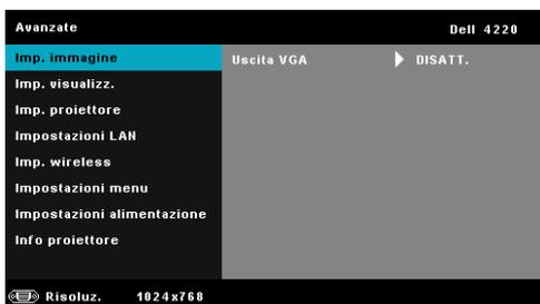
**USCITA VGA**—Selezionare Attiva o Disatt. per attivare/disattivare la funzione d'uscita VGA quando il proiettore è in stato di standby. L'impostazione predefinita è Disatt..
