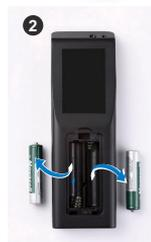
3 Inserire le batterie e allineare correttamente la polarità in base all'indicazione nel vano batterie.
