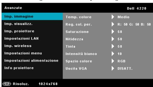
**TEMP. COLORE**—Consente di regolare la temperatura colore. La schermata appare più fredda a temperature colore più alte e più calda a temperature più basse. Quando si regolano i valori nel menu **Regol. colore**, viene attivata la modalità Pers. I valori vengono salvati nella modalità Pers.
